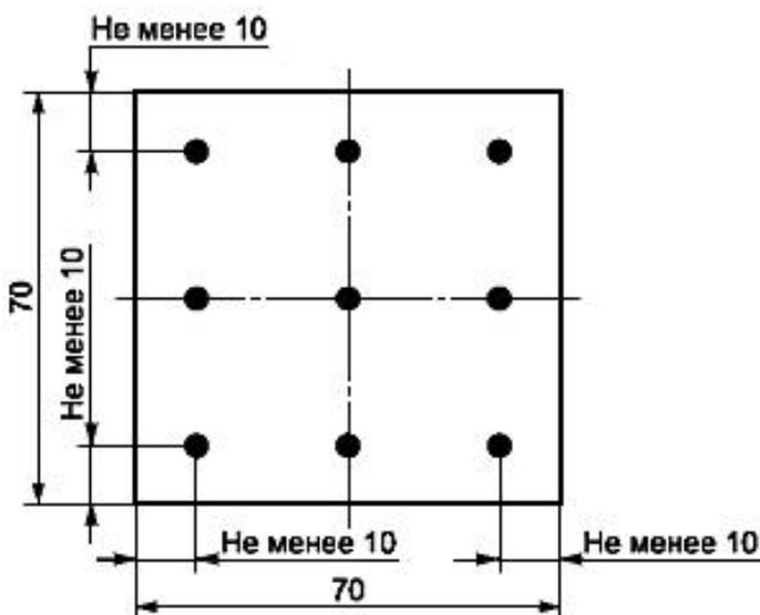
Рисунок 1 - Точки измерения толщины образца
